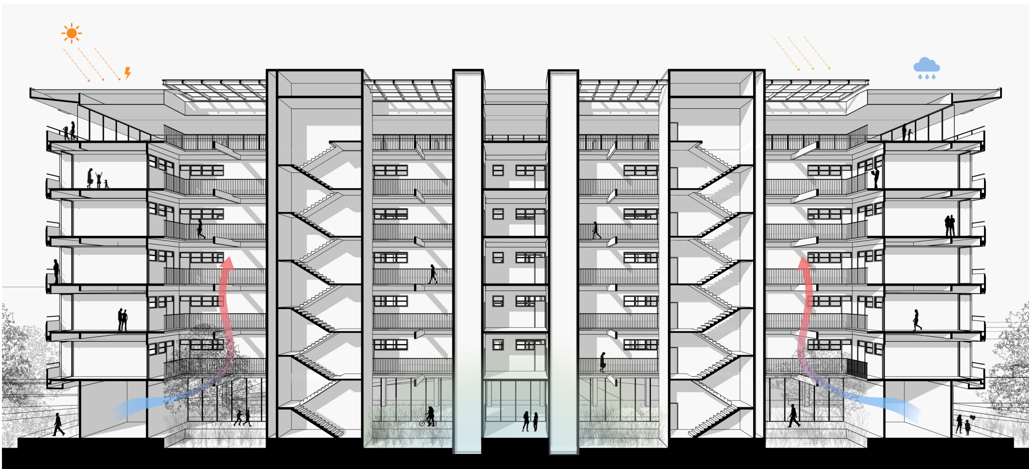
CORTE PERSPECTIVADO BIOCLIMÁTICO Para melhorar o conforto térmico e a eficiência energética do edifício, foram adicionadas placas solares na cobertura e um sistema de coleta e reuso de água da chuva, que reaproveita as calhas originais. Sobre os novos vazios nas lajes, foi criada uma cobertura de vidro levemente descolada da existente, pois isso permite a ventilação natural e gera o efeito chaminé, além de iluminação. Por causa dos vazios, os apartamentos possuem janelas voltadas tanto para a fachada quanto para o corredor, garantindo ventilação cruzada.
